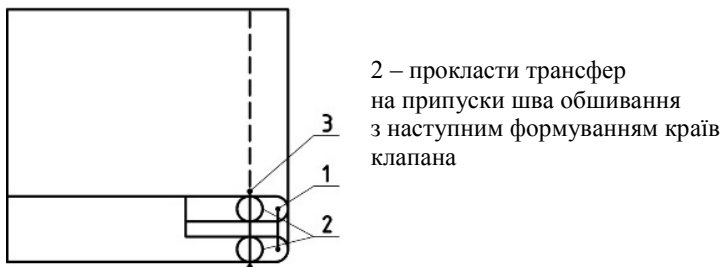
Рис. 1.7 – Обробка клапана підкладкою зі штучної шкіри обшивним швом з оздоблювальною строчкою
