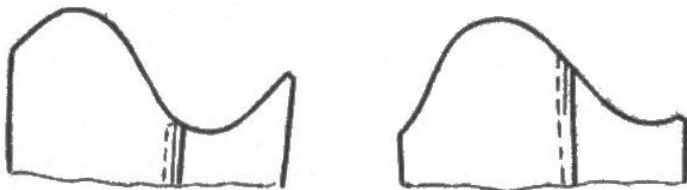
Рис. 1.7 – Перевірка спряженості ліній оката рукава
